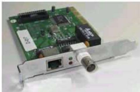
Placa de rede para rede com Cabo Coaxial
